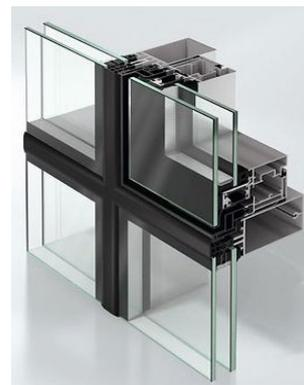
**FACCIATA CONTINUA tipo SERIE SCHÜCO FWS 50 o equivalente (a partire dalla quota 320 cm)** realizzata con profilati in alluminio a taglio termico in lega primaria di alluminio EN AW-6060. Finitura superficiale: preverniciatura colore RAL9010.
