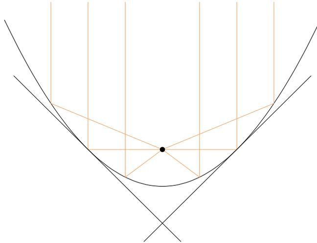
Per applicare la seconda parte della legge di riflessione, basta notare che, per uno specchio non rettilineo, l'angolo di incidenza (o di riflessione) è, per definizione, l'angolo formato tra il raggio incidente (o riflesso) e la *retta tangente* allo specchio.
