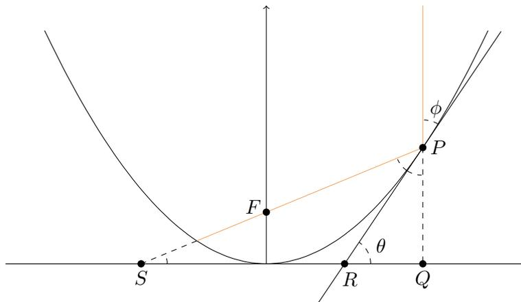
Sia  $\phi$  l'ampiezza dell'angolo tra il raggio incidente e la retta tangente a  $\mathcal{P}$  in  $P = (x_0, \frac{1}{4}x_0^2)$ , generico punto della parabola. Per la legge di riflessione, anche l'angolo  $\widehat{SPR}$  è uguale a  $\phi$ . L'angolo  $\widehat{RPQ}$  misura anch'esso  $\phi$ , dunque, ricordando che la somma degli angoli interni di un triangolo è  $\pi$ , otteniamo che  $\theta = \frac{\pi}{2} - \phi$ , dunque  $\psi = \frac{\pi}{2} - 2\phi = 2\theta - \frac{\pi}{2}$ .
